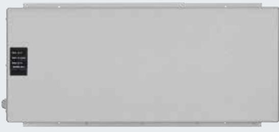
USV-Anlage zur Überbrückung von Spannungsausfällen bis zu 4 Stunden, Sicherheitseinrichtungen, Signalleuchten etc. bleiben in Funktion, LED-Zustandsanzeige, automatischer Batterietest, ÜberspannungsfILTER, Abmessungen: 560 x 235 x 260 mm (B x H x T), Schutzart: IP 20
